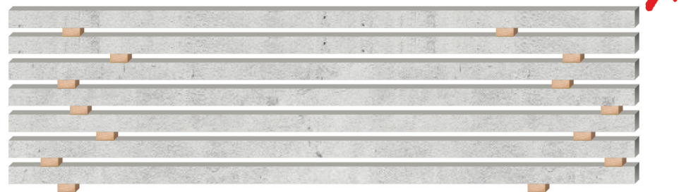
Afb. 2: Badding hout niet in één rechte lijn. Pas op: breekgevaar!
